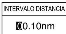
Margen de ajuste: 0,01 nm (continuo) - 99,99 nm (km, sm)
