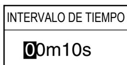
Margen de ajuste: 0 min 1 s (continuo) - 99 min 59 s
