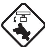
**Apague el interruptor de encendido del radar antes de realizar mantenimiento en la unidad de antena. Ponga un rótulo de advertencia cerca del interruptor que indique que no se debe encender mientras se esté realizando mantenimiento en la unidad de antena.**
